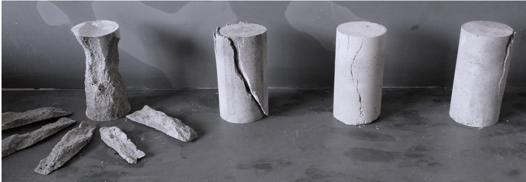
Figura 6.1 – Rompimentos distintos de corpos de prova cilíndricos após ensaio de compressão unidimensional (Fonte: https://propriedadesdoconcreto.blogspot.com/2016/12/a-forma-de-rompimento-do-cp-e-importante.html )
