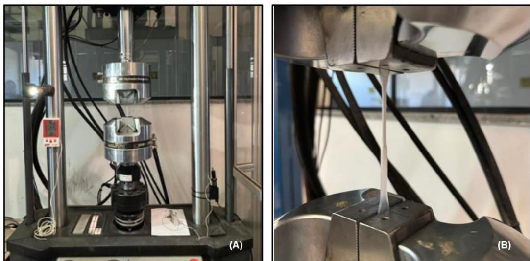
**Figura 8. (A)** - Equipamento MTS 810; **(B)** - Ensaio de tração em um corpo de prova 100% PP. **Fonte:** Autora.
