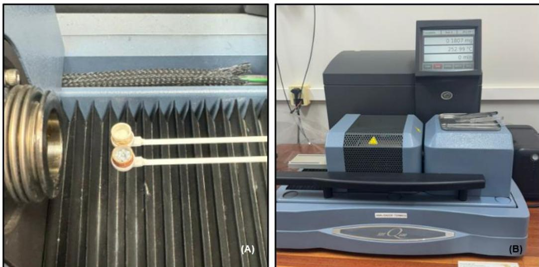
**Figura 10.** (A) - Equipamento SDT Q600; (B) - Cadiños com amostra. **Fonte:** Autora.
