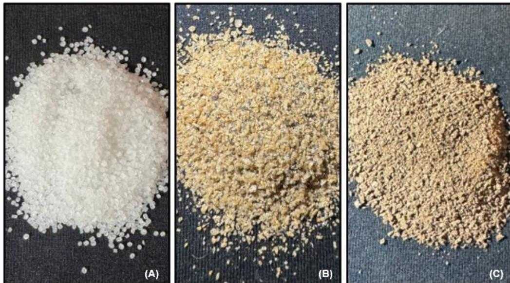
**Figura 3.** (A) - Pellets 100%PEAD; (B) - Pellets da mistura 25% macaúba 75% PEAD; (C) - Pellets 25% babaçu 75% PEAD. **Fonte:** Autora.
