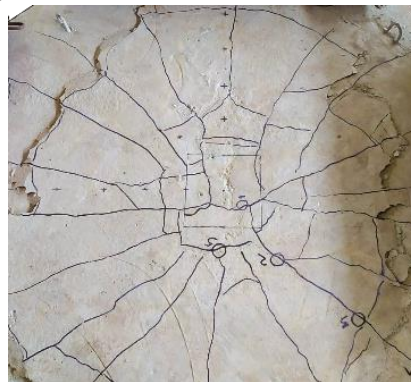
Figura 4.13 – Mapa de fissuração das lajes com \rho = 0,7\% .
