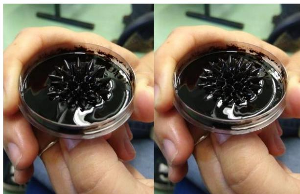
Figura 1 Ferrofluido obtido pelo método Massart.
