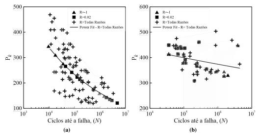
Figura 5.9. Diagrama de Kwofie versus vida: a) Al 2024-T3. b) SAE 4130.
