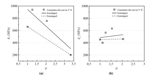
**Figura 5.3.** Estratégias de calibração da constante de A versus  $\rho$ : a) Al 2024-T3.b) SAE 4130.
