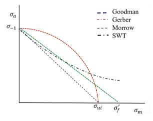
Figura 2.4. Efeito da tensão média na resistência à fadiga.
