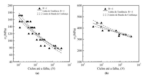
**Figura 5.7.** Diagrama  $\sigma_a - N$ : a) Al 2024-T3. b) SAE 4130.
