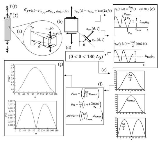
Figura 4.2. Representação esquemática para determinação dos planos críticos.
