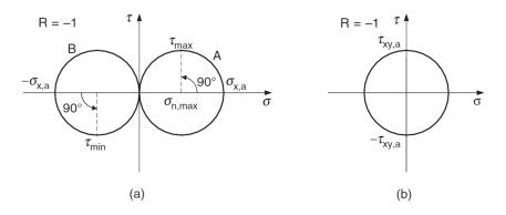
**Figura 3.6.** Círculo de Möhr: a) Carregamento reverso de Tração/Compressão. b) Carregamento reverso de torção [Susmel, 2009].
