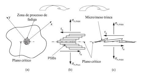
Figura 3.4. Bandas de deslizamento persistentes, Fonte: Modificada Susmel [2009].
