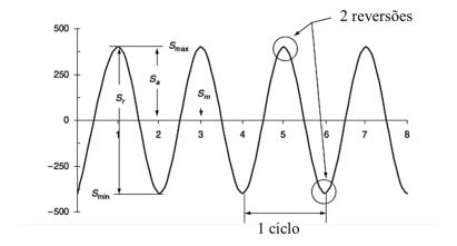
Figura 2.2. Representação do ciclo de tensão senoidal.
