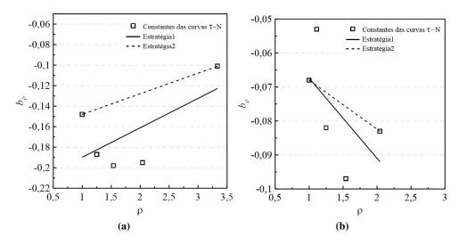
**Figura 5.4.** Estratégias de calibração da constante *b versus*  $\rho$ : a)Al 2024-T3.b) SAE 4130.
