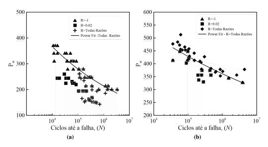
Figura 5.8. Diagrama de Walker versus vida: a) Al 2024-T3. b) SAE 4130.
