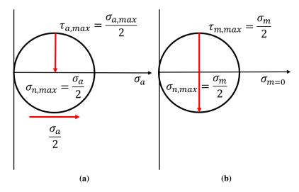
**Figura 4.4.** Representação do círculo de Mohr sob carregamento de tração: a) Considerando amplitude de tensão normal. b) Considerando amplitude de tensão média.
