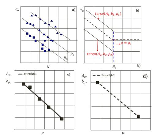
**Figura 4.3.** Representação esquemática para calibração das constantes da curva  $\tau_-N$ .
