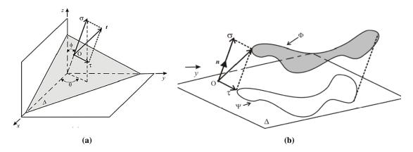
**Figura 3.3.** Representação: a) Vetor tensão  ${\bf t}$  e suas componentes normal e cisalhante no plano  $O_{xyz}$ . b) Projeção do vetor  ${\bf t}$  sobre o plano para um período de um ciclo de carregamento, Susmel et al. [2005].
