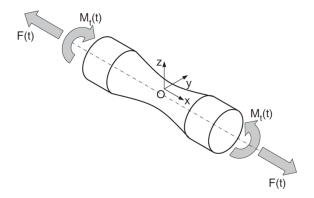
Figura 3.5. Espécime submetido a carregamento de tensão biaxial, Susmel [2009].
