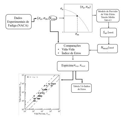
**Figura 4.1.** Representação esquemática da estratégia de avaliação da aderência dos modelos para estimativa de vida sob efeito da tensão média sobre a resistência à Fadiga.
