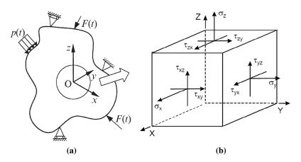
**Figura 3.1.** Representação: a)Forças externas atuante em um ponto material.b) Componentes de tensão em um plano infinitesimal [Carpinteri et al., 2008, Fatemi and Socie, 1988].
