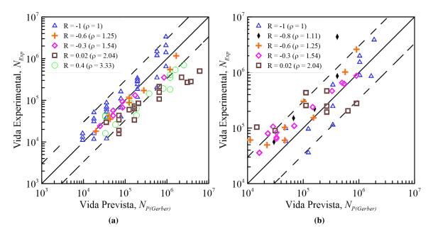
Figura 5.10. Diagrama vida-vida modelo Gerber: a) Liga Al 2024-T3. b) Liga SAE 4130.
