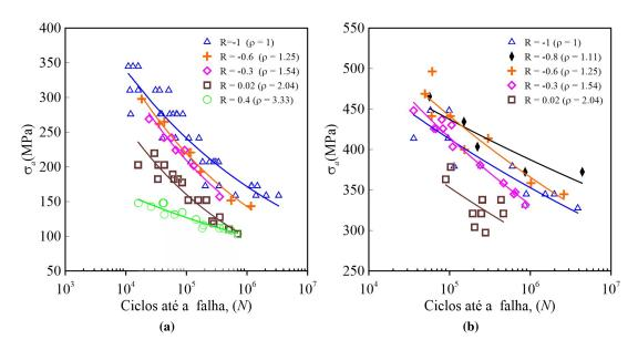
**Figura 5.1.** Diagrama  $\sigma_a - N$ : a) Al 2024-T3. b) SAE 4130.
