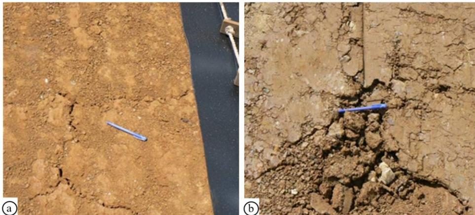
Figura 2.29 - CCL sob a GM: a) CCL apresenta fissuras de dessecação; b) superfície classificada como má qualidade para contato (Rowe & Hosney, 2010).
