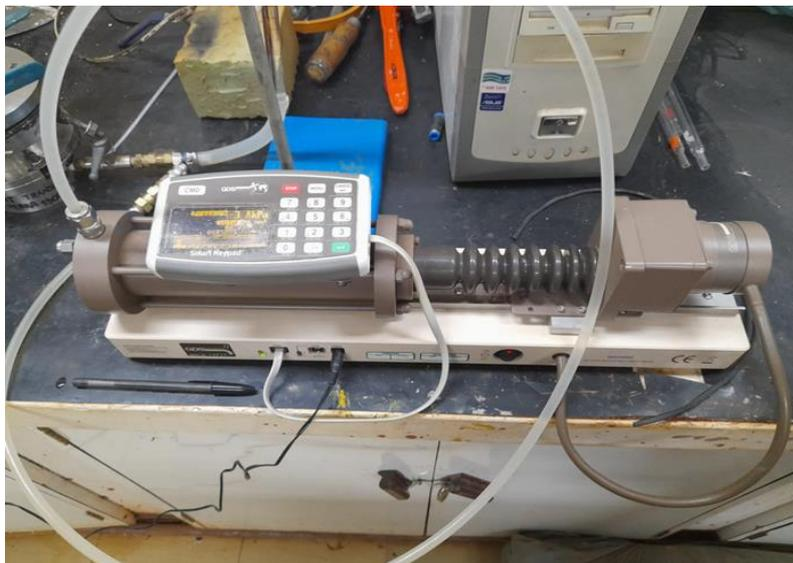
Figura 3.23 - Equipamento padrão de controle de pressão e volume GDS para calibração dos transdutores de pressão.
