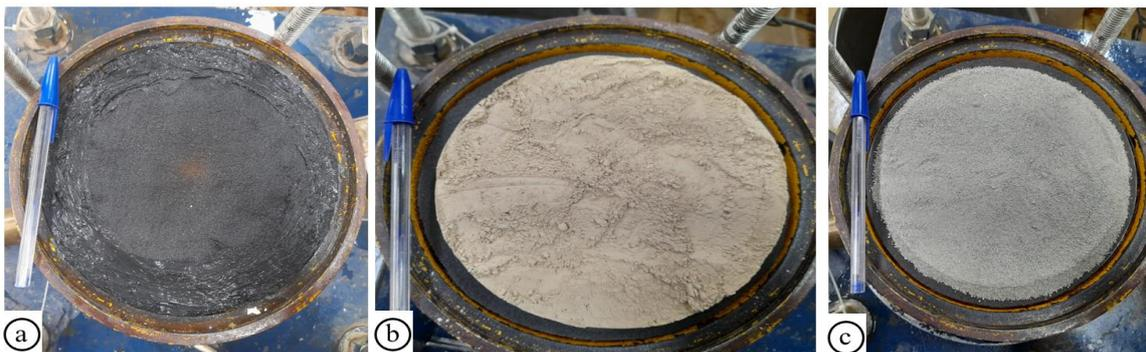
Figura 3.33 - Amostras instaladas no equipamento: a) geocomposto (GCL-C); b) geocomposto (GCL-D); c) geocomposto (GCL-E).
