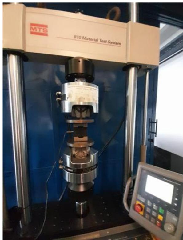
Figura 3.21 - Calibração da célula de carga no Laboratório de Engenharia Mecânica da UnB.
