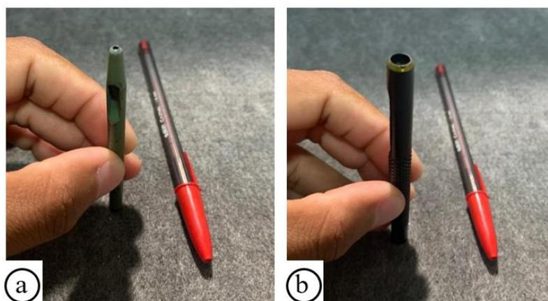
Figura 3.30 – Vazadores utilizados para provocar danos por furos em geomembranas: a) vazador com furo de  $\varnothing$  2,2 mm; b) vazado com furo de  $\varnothing$  5 mm.
