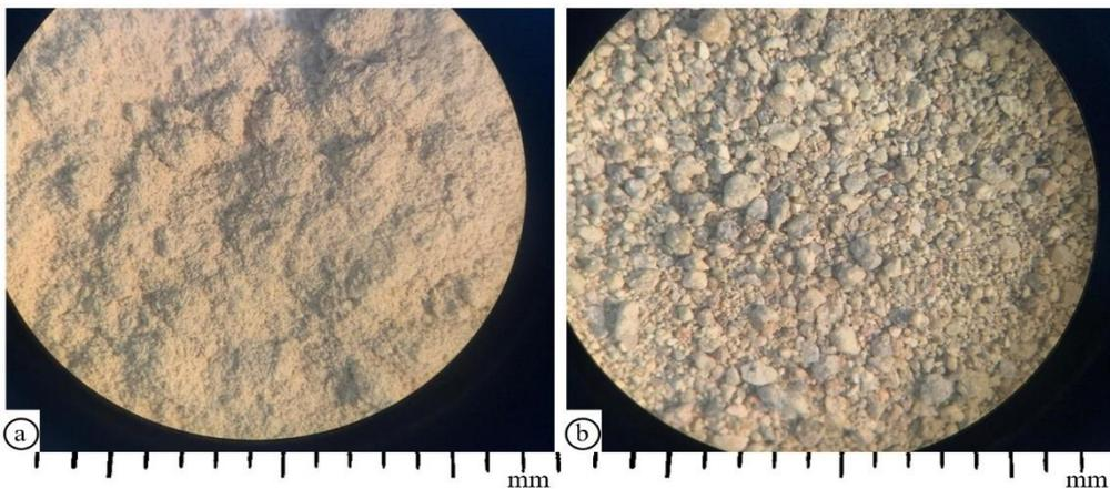
Figura 3.16 - Amostra de bentonitas: a) bentonita sódica em pó (GCL-A); b) bentonita sódica granulada (GCL-B).
