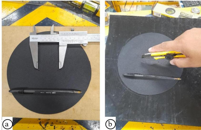
Figura 3.28 - Espécime de geomembrana de PVC: a) corte linear de 50 mm (mensuração do tamanho do dano com paquímetro; b) realização do corte com estilete.
