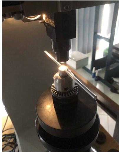
**Figura 3.10.** Corpo de prova posicionado na plataforma do durômetro Zhu250 para produção da marca de indentação Brinell.
