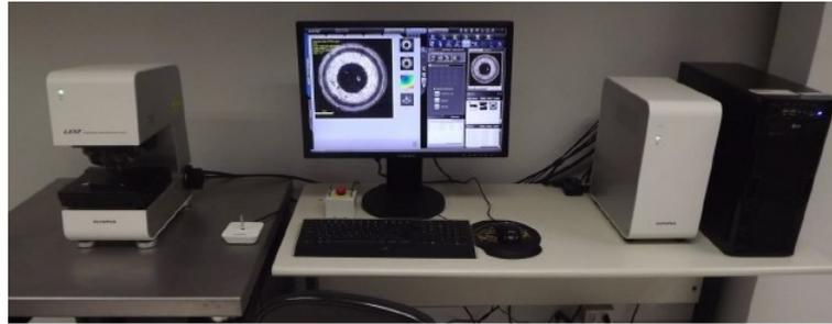
**Figura 3.5.** Microscópio Confocal Laser modelo LEXT OLS4100.
