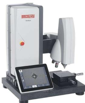
**Figura 3.9.** Equipamento para medição de microdureza Vickers, EmcoTest DuraScan 20, com indentador de diamante e lentes de aproximação de 10x e 40x.
