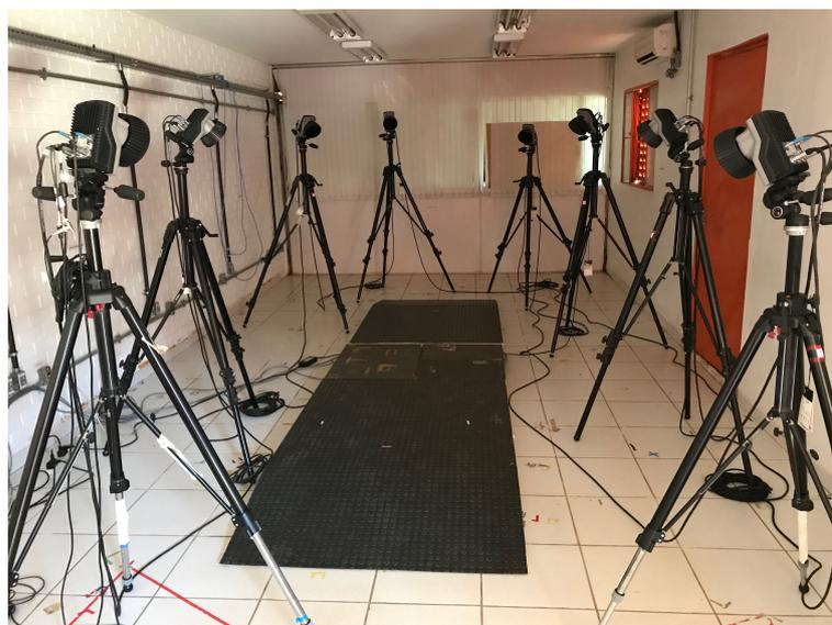
Figura 17 – Posicionamento das 8 câmeras de infravermelho.
