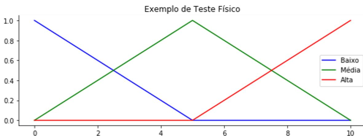
Figura 4 – Funções de Pertinência de Entrada para o Controlador *Fuzzy*
