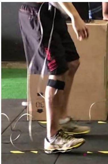
Figura 21 – Posicionamento do Sensor IMU.
