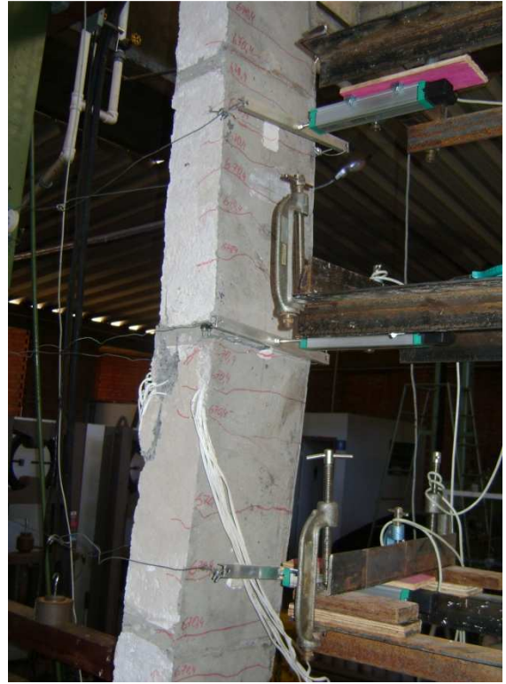
Figura 4.5 - Fissuras no Pilar PFN 15 - 2,5
