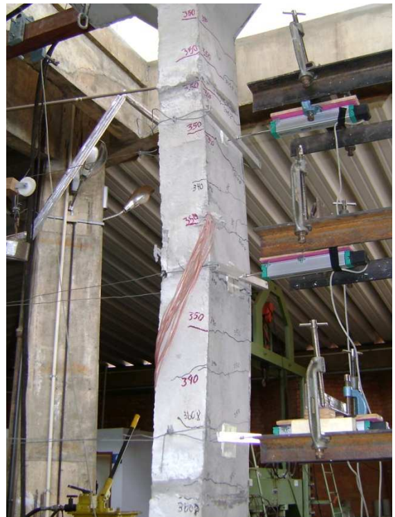
Figura 4.7 - Fissuras no Pilar PFN 24 - 2,5
