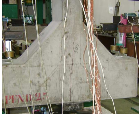
Figura 4.3 - Fissura no modelo PFN 0 - 2,5
