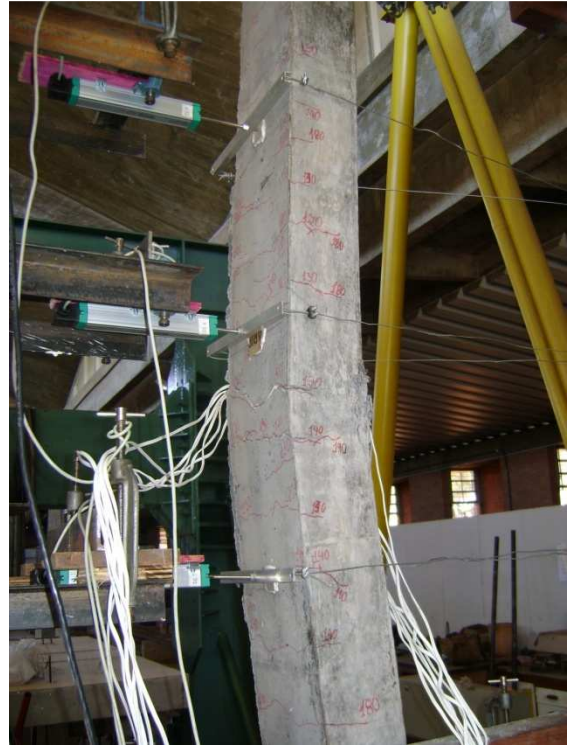
Figura 4.13-Fissuras no Pilar PFN 50 - 2,5
