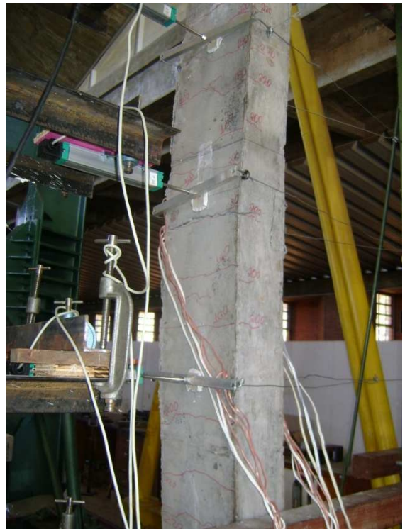
Figura 4.11-Fissuras no Pilar PFN 40 - 2,5
