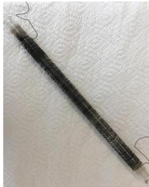
**Figura 31: Tubo de quartzo com fio de nicromo enrolado ao longo do comprimento usado para realizar os tratamentos térmicos.**
