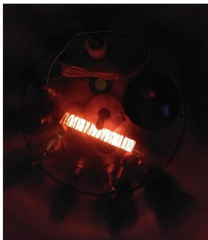
**Figura 33: Tratamento térmico do filme de ZnO na temperatura de 773 K.**
