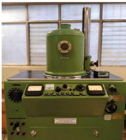
**Figura 24: Sistema de deposição usada para crescer os filmes de ZnO.**
