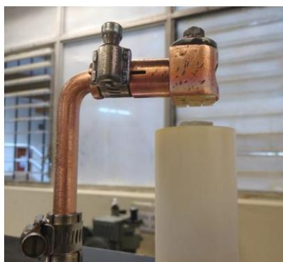
**Figura 23: Montagem dos eletrodos na câmara de vácuo para a deposição.**
