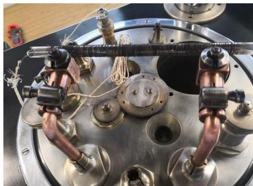
**Figura 32: Montagem para tratamento térmico em vácuo.**
