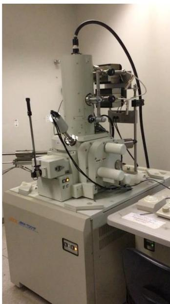
**Figura 35: Microscópio Eletrônico de Varredura (MEV) JEOL, modelo JSM 7001 - F, no Laboratório de Microscopia Eletrônica no Instituto de Ciências Biológicas da UnB.**
