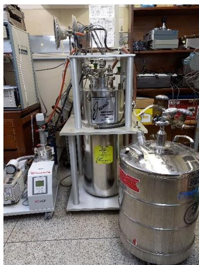
**Figura 39: Estação de medidas elétricas resfriado com nitrogênio líquido**
