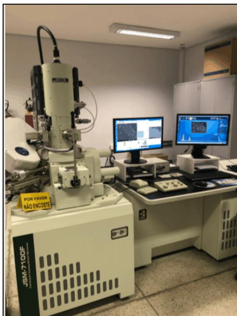
Figura 3.15 - Microscópio Eletrônico de Varredura por emissão de campo modelo JEOL JSM-7100F.
