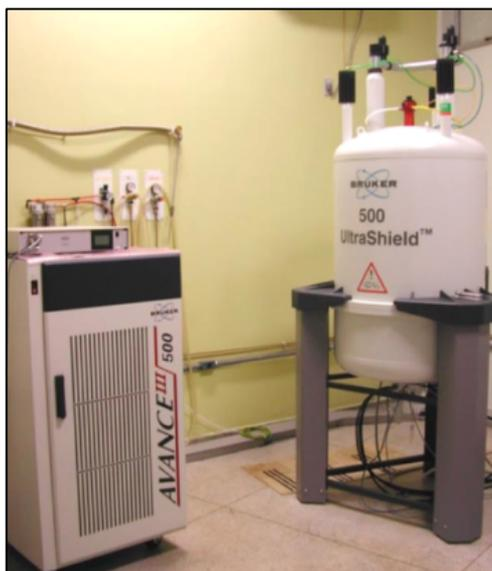
Figura 3.18 - Equipamento Bruker Avance III 500 11,75T.
