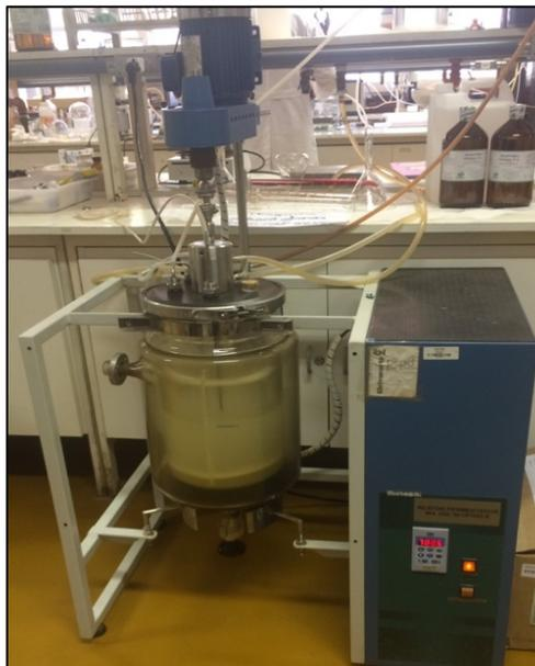
Figura A.3 - Reator Fermentador utilizado na produção da NSF/E do Estudo Preliminar.
