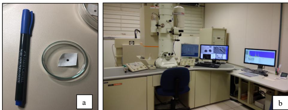
Figura 3.12 - (a) Detalhe da amostra para ensaio MET; (b) Microscópio Eletrônico de Transmissão modelo JEM-2100.
