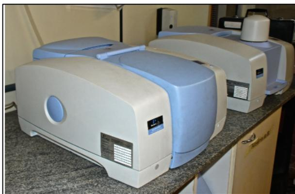
Figura 3.17 - Espectrofotômetro PerkinElmer utilizado nas análises de FTIR.
