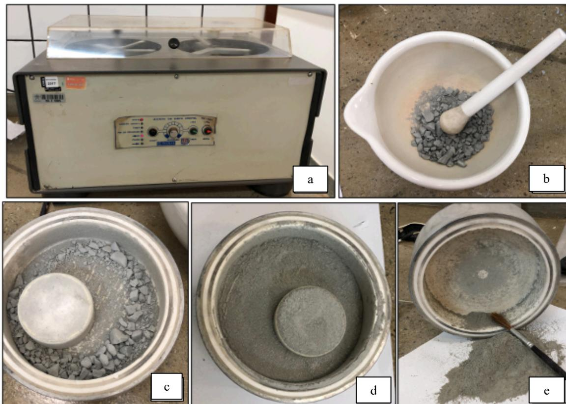
Figura 3.26- Preparo da amostra das pastas em forma de pó: (a) Moinho de disco e câmara em cerâmica com movimento orbital utilizado na trituração das pastas; (b) Amostra previamente triturada; (c) Pastas dentro a câmara do moinho; (d) Pastas pulverizadas após tempo de 5 minutos; Retirada das pastas pulverizadas do moinho de disco.
