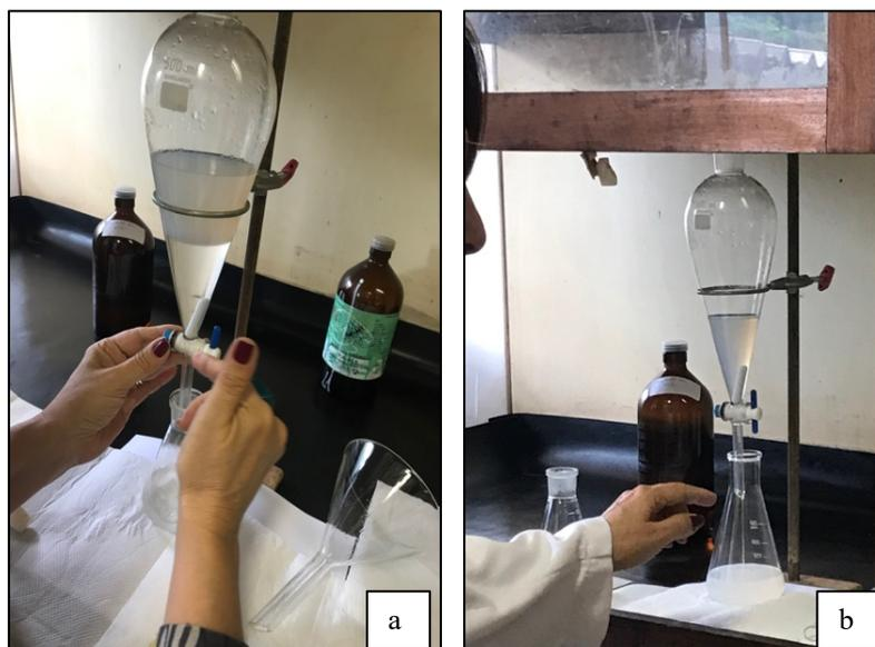
Figura A.5 - Separação da fase orgânica da NSF/D utilizando um funil: (a) Detalhe das fases distintas no funil indicando fase orgânica e fase aquosa; (b) Fase orgânica sendo retirada da mistura.
