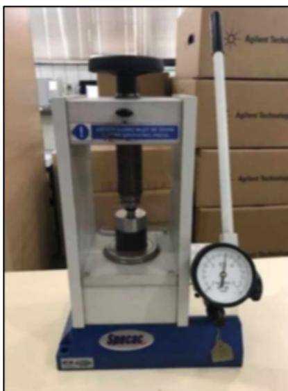
Figura 3.36 – Prensa para preparo das pastilhas do ensaio de FTIR das amostras das pastas.
