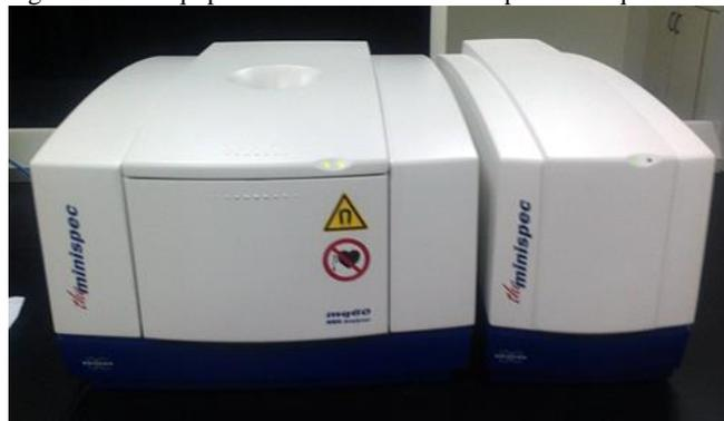
As amostras eram misturadas conforme descrito no item 3.3.1 e inseridas num tubo de ensaio de vidro, seladas com plástico filme e posicionadas imediatamente após a mistura dentro do equipamento para início de aquisição de dados.
