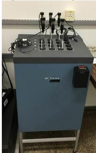
O objetivo desse ensaio é avaliar a liberação de calor proveniente das reações químicas do contato do cimento com a água e demais adições, possibilitando analisar a influência do SAP e da nanosílica nas reações de hidratação das pastas de cimento estudadas.
