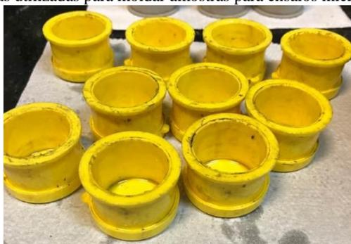
Alcançada a idade desejada (1, 3, 7 e 28 dias), as amostras foram cortadas em laminas de cerca de 3mm, sendo desprezadas as extremidades (Figura 3.9a), e imersas em isopropanol por 7 dias (Figura 3.9b), sendo esse líquido trocado após decorridas as primeiras 24 horas. As amostras em que seriam realizados os ensaios de porosimetria por intrusão de mercúrio foram cortadas em cubos com cerca de 1cm de aresta. Decorrido
