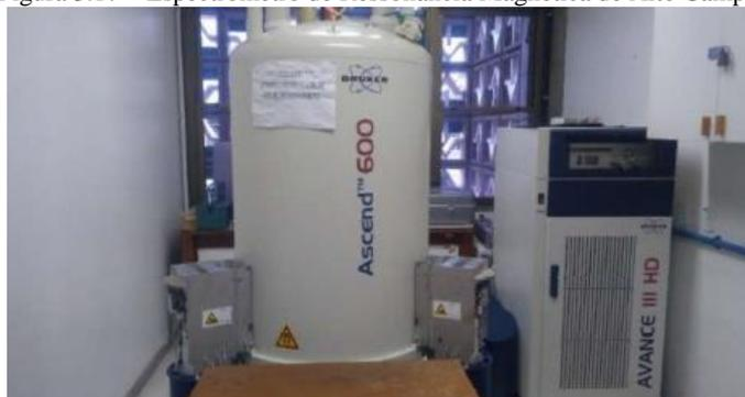
Para tratamento dos dados obtidos pelos ensaios de RMN, utilizou-se o software TopSpin fornecido pelo fabricante do equipamento (BRUKER), onde foi possível analisar os espectros fazendo a retirada do ruído e seguir com a deconvolução das curvas, selecionando os picos de interesse para cálculo da área sob cada curva obtida a partir da deconvolução.
