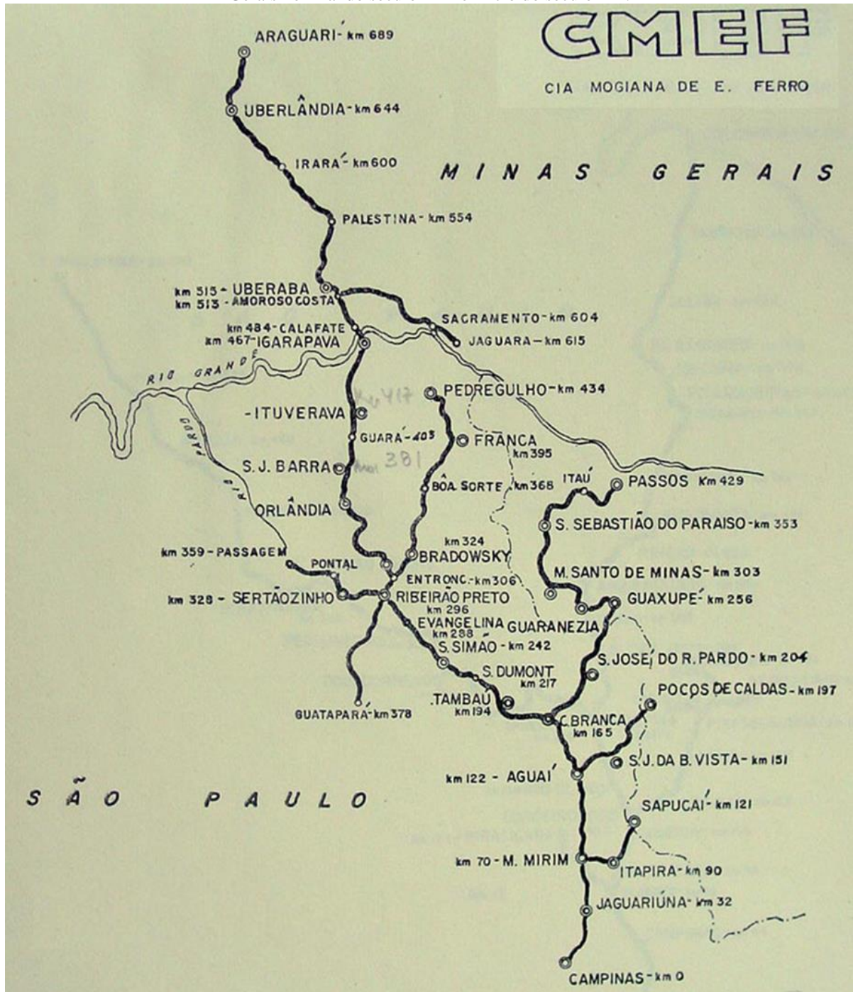
Figura 01: Croqui do traçado da Companhia Mogiana de Estrada de Ferro no Estado de São Paulo e Minas Gerais no final do século XIX e início do século XX.
