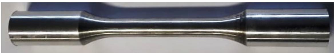
Figura 3.3: Corpo de prova utilizado no ensaio de tração monotônico.
