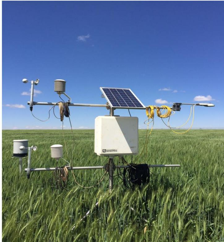
**Quadro 2.** Equipamentos instalados na estação micrometeorológica.
