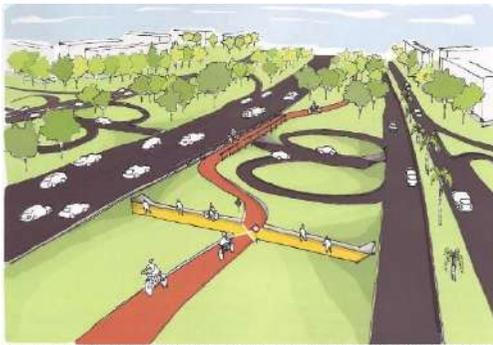
Perspectiva arquitetônica do encontro da ciclovia com a passagem de pedestres (em nível) e o túnel da passagem subterrânea de um ponto adaptado ao visual. A ciclovia atua como mais um elemento revitalizador das passagens.
