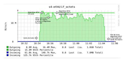
Figura 3.2: Exemplo de funcionamento dos Algoritmos Dinâmicos no Serviço QoS-Flux.
