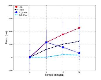
Figura 4.5: Atraso Utilizando Todos os Fluxos.
