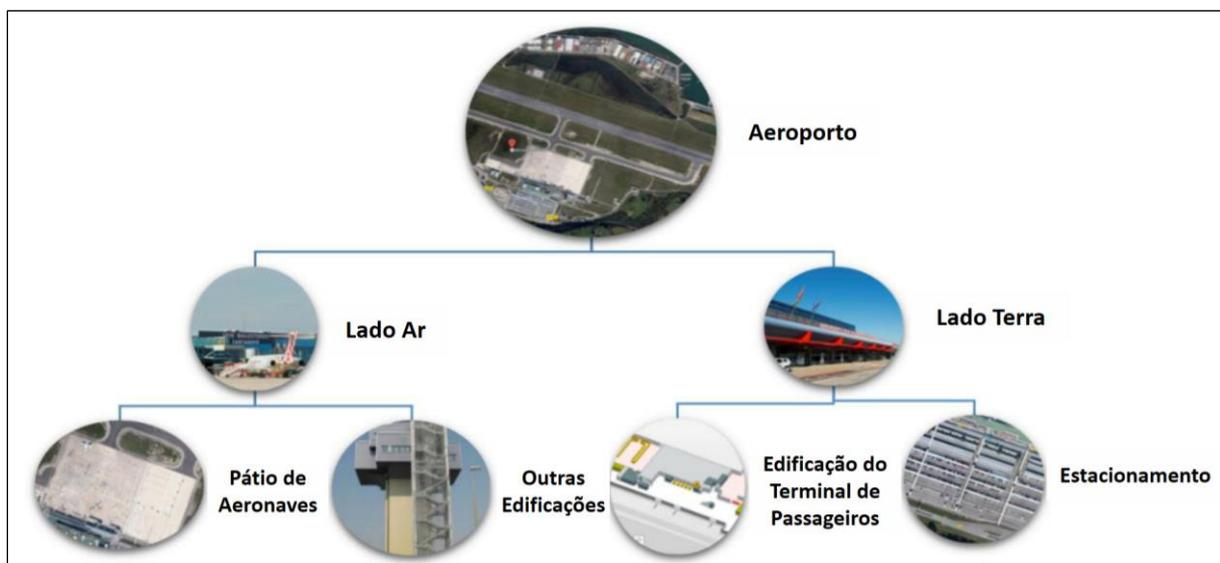
**Figura 2.4:** Esquema de subsistemas de aeroportos
