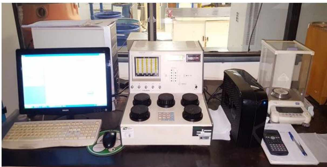
Figura 3.5 – Pentapicnômetro ( Pentapyc™ 5200e ) e sistema de aquisição de dados.
