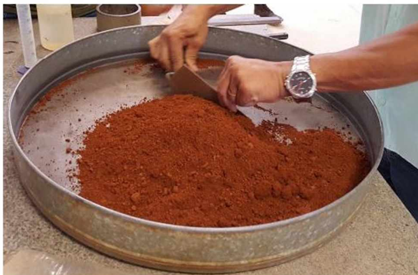
Figura 3.11 – Preparação do material para ensaios de compactação e ISC.
