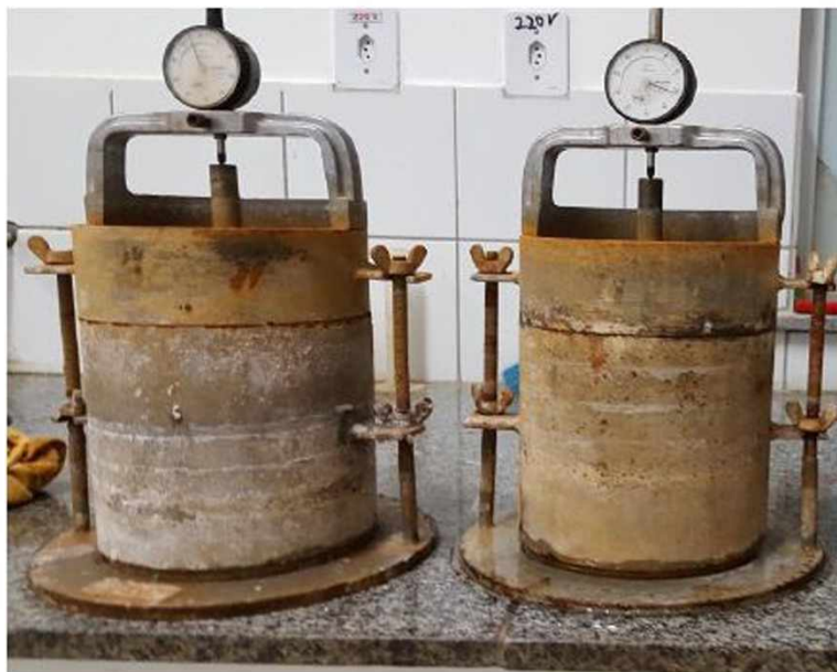
Figura 3.18 – Moldes com amostras após os 14 dias de expansão.
