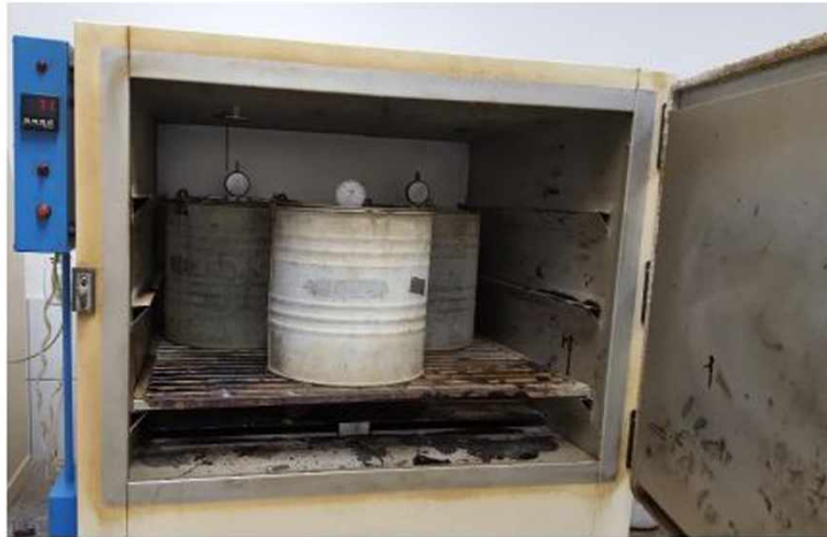
Figura 3.17 – Amostras preparadas na estufa para ensaios de potencial de expansão.
