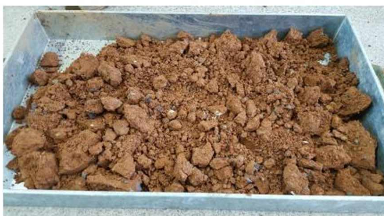
Figura 4.30 – Amostra da mistura M5050 após ensaio de avaliação do potencial de expansão.
