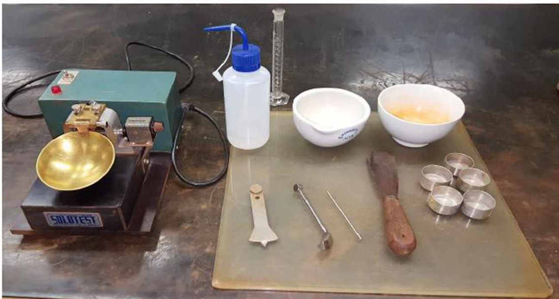
Figura 3.2 – Materiais e aparelhos utilizados nos ensaios dos limites de Atterberg.
