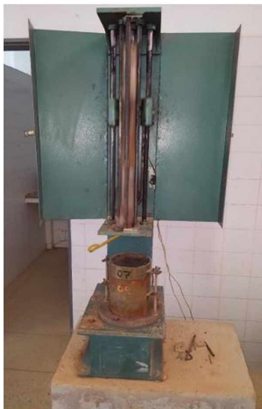
Figura 3.12 – Soquete CBR/Proctor automática (Solotest).
