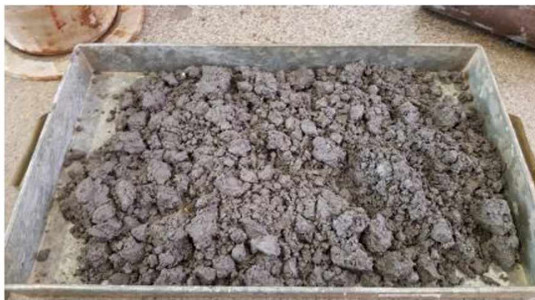
Figura 4.26 – Amostra de açobrita após ensaio de avaliação do potencial de expansão.
