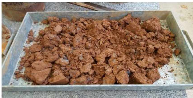
Figura 4.32 – Amostra da mistura M6040 após ensaio de avaliação do potencial de expansão.
