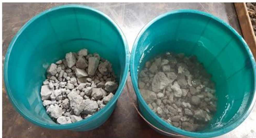
Figura 3.6 – Ensaio de determinação da absorção de água do açobrita.
