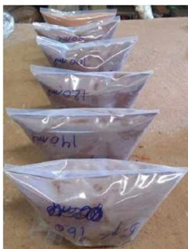
Figura 3.8 – Amostra de solo tropical para ensaio de compactação em equipamento miniatura – mini MCV e perda de massa por imersão.
