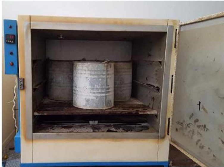
Figura 3.15 – Calibração da estufa utilizada no ensaio de potência de expansão.
