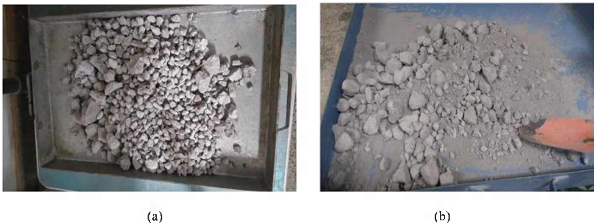
Figura 4.12 – Açobrita na graduação A (a) antes e (b) após o ensaio de abrasão “Los Angeles”.
