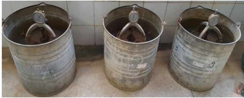
Figura 3.13 – Corpos de prova imersos para verificação da expansão.
