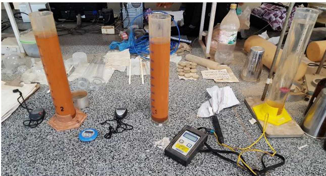
Figura 3.3 – Ensaio de granulometria por sedimentação.
