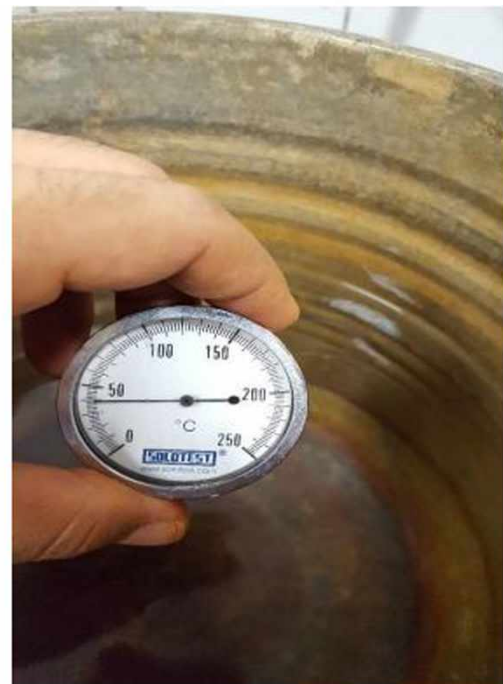
Figura 3.15 – Calibração da estufa utilizada no ensaio de potência de expansão.
