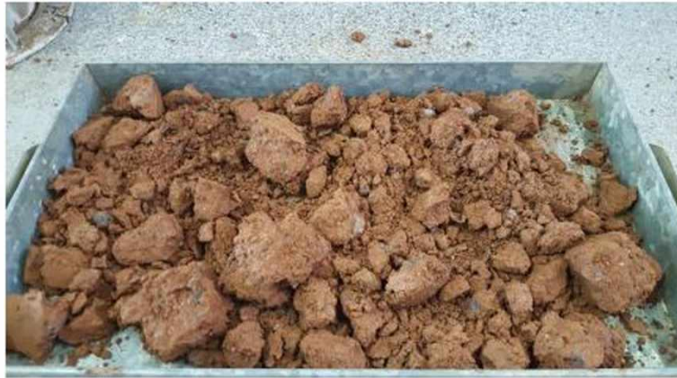
Figura 4.28 – Amostra da mistura M4060 após ensaio de avaliação do potencial de expansão.
