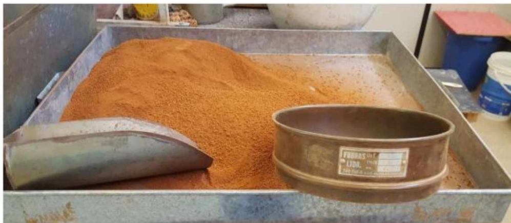
Figura 3.7 – Preparação da amostra de solo tropical para classificação na metodologia MCT.
