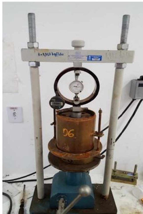
Figura 3.14 – Prensa CBR/ISC manual 5.000kgf (Solotest).
