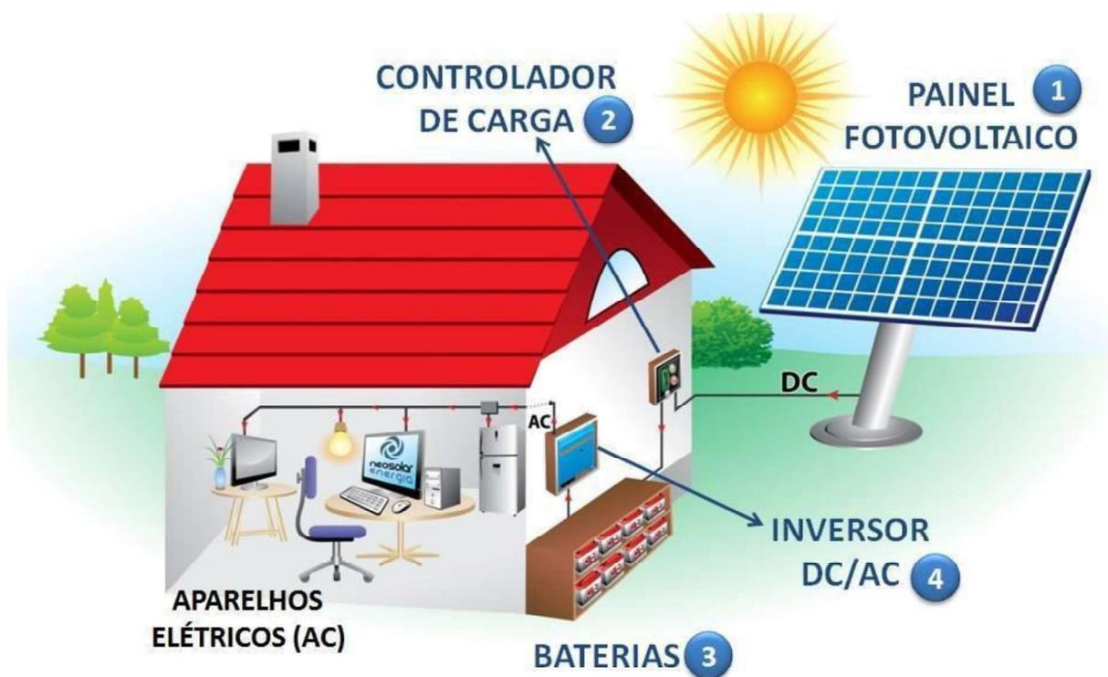
Figura 1 Sistema fotovoltaico.
