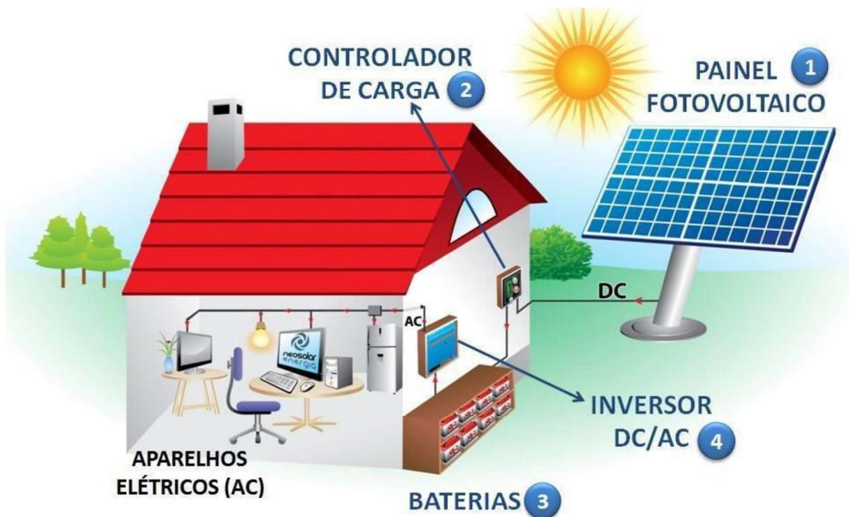
Figura 1 Sistema fotovoltaico.
