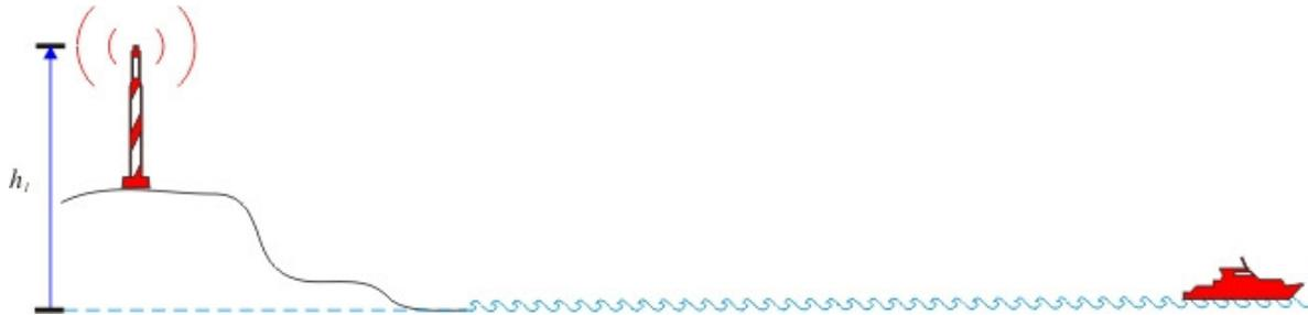
**Figura 2-5 - Cálculo da altura da antena transmissora para percurso marítimo.**
