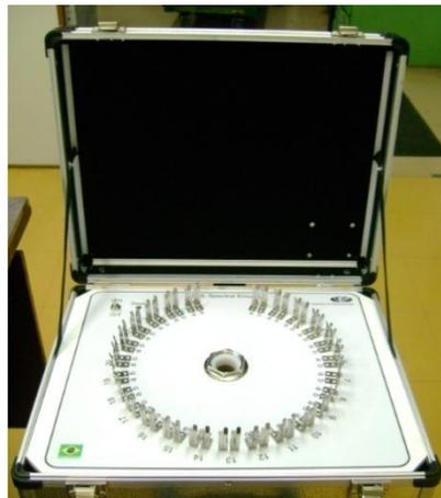
Figura 3. 11 - Gerador de ruído ADSL e HDSL.
