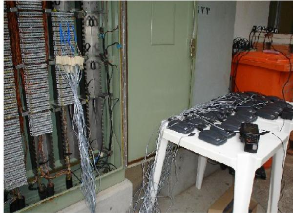
Figura 5.5 - Montagem dos vinte e quatro *modems* ADSL no armário de distribuição para executar os testes de carregamento do grupo de pares do cabo.
