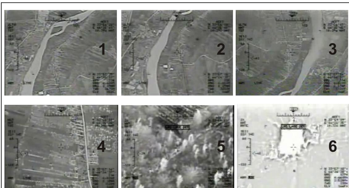
**Figura 40 – Seqüência de quadros demonstrando o uso do modo caçar-destruir do SERAPH com emprego de RASURA, InSAR e Termal e indicação de uma tropa abaixo das árvores para fogo realizado pelo SKUA.. Fonte: DENEL, 2007.**
