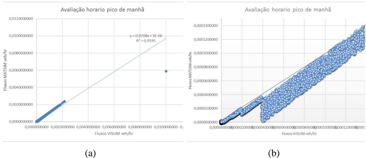
Figura 5.10 Comparação de fluxos simulados em cada arco entre VISUM e MATSIM (a) Total analisado; (b) aproximação visual na escala.
