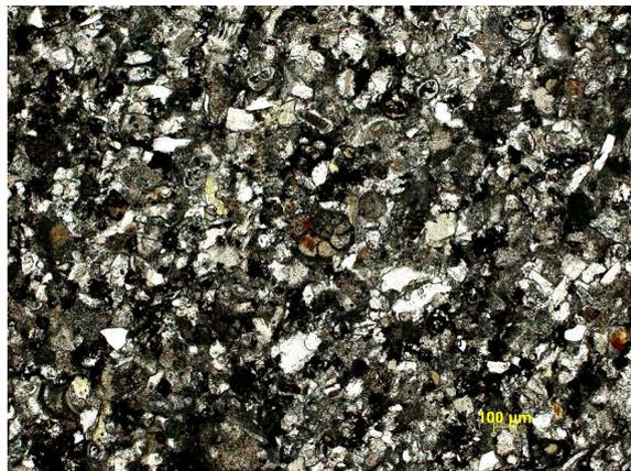
Figura 22 – Arenito híbrido com bioclastos e fragmentos de rocha vulcânica dispersos, matriz argilosa. Perfil C, amostra 39.
