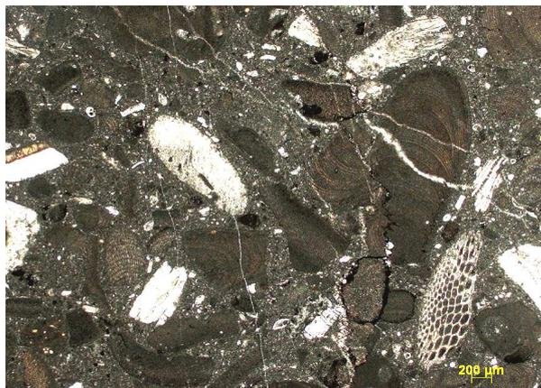
**Figura 17 – Packstone de fragmentos de algas vermelhas, com fraturas preenchidas por calcita espática. Perfil D, amostra 85.**
