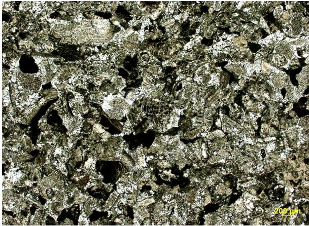
**Figura 11 – *Grainstone* com macroforaminíferos e equinóides quebrados, notar a cimentação sintaxial em torno dos equinodermas, e também cimentação espática obliterando porosidade. Perfil B, amostra 51.**
