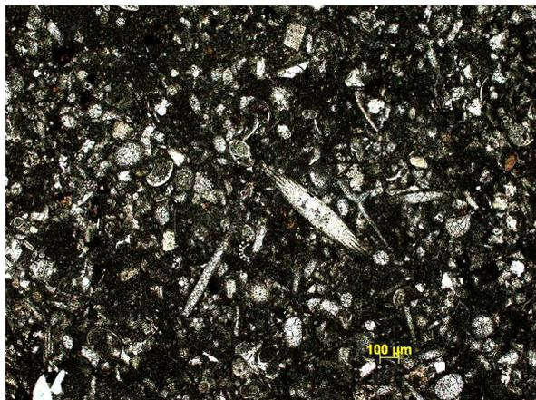
**Figura 13 – *Packstone/Wackestone* argiloso com foraminíferos planctônicos. Ocorrem fragmentos líticos de composição vulcânica dispersos. Perfil D, amostra 97.**
