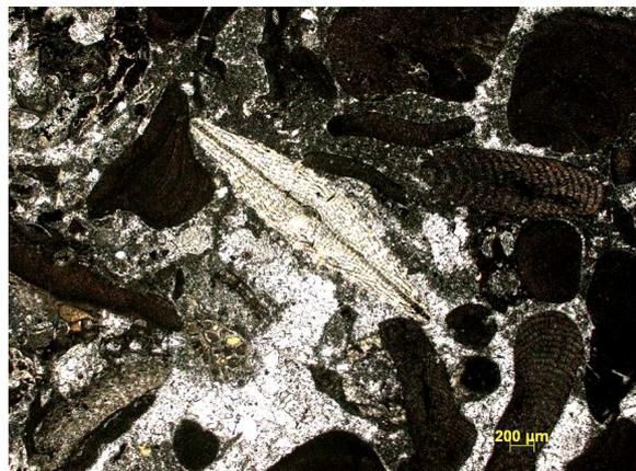
**Figura 18 – Packstone de fragmentos de algas vermelhas, cimentado. Perfil C, amostra 49.**
