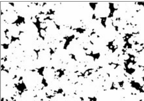
Figura 3. Imagem de área dos macroporos na lâmina delgada do solo natural.
