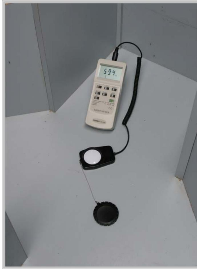
Figura 7. Luxímetro colocado no interior do aparato para medição de luminosidade no mesmo. Observe que a fotocélula foi posicionada exatamente no centro do mesmo, local onde o animal tem a visão dos dois estímulos e de onde efetua a escolha.
