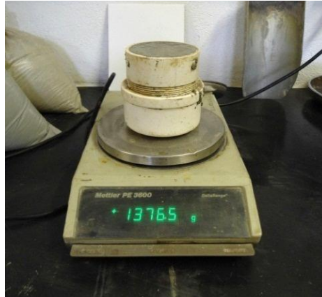
Figura 3.11 – Pesagem do recipiente de volume conhecido para a determinação da densidade dos microconcretos
