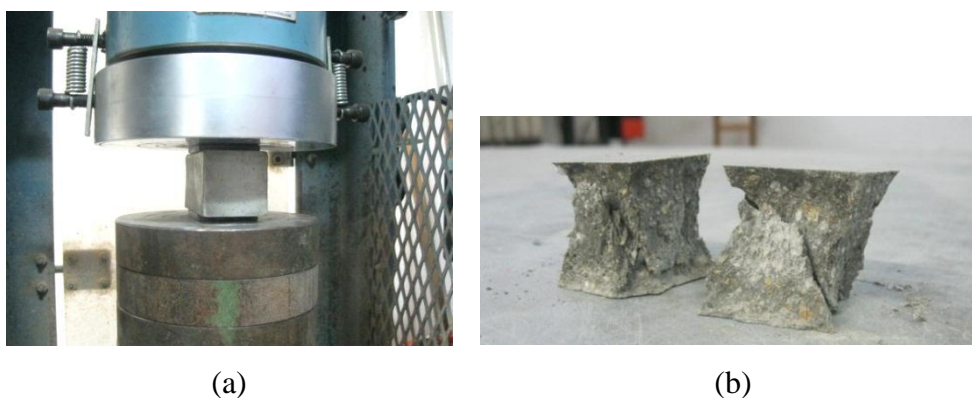
Figura 3.18– Ensaio de resistência à compressão dos cubos: a) ensaio e b) corpos-de-prova depois da ruptura
