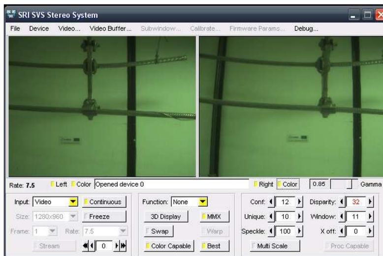
Figura 4.2: Tela do software de aquisição de imagens SRI- Small Vision System.
